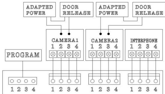
\* Каждое устройство должно быть подключено отдельным кабелем. Если вы используете UTP кабель [CAT.5] для камеры 1 и камеры 2, требуется 2 линии UTP кабеля.
